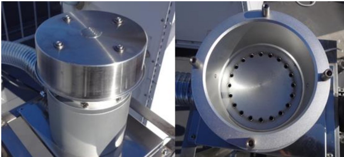
図(1)-4 バーチャルインパクトの写真 左：全体 右：ノズル部分
