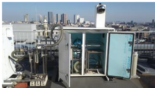
図(1)-1 PM 2.5 と粗大粒子の新規大流量同時採取装置 (K0VI-2C-1200Z) 概略図
