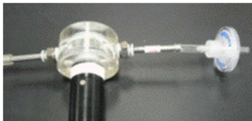
図4.1.12 金捕集管を利用した基準ガス（ゼロガス）吸引の一例
