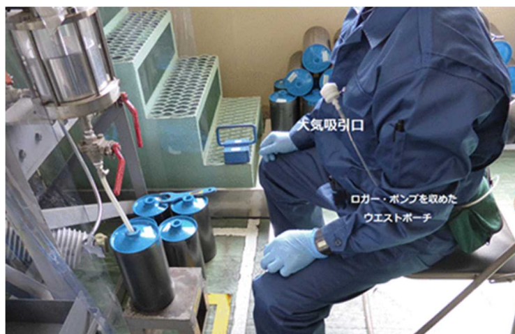
図4.1.14 国内における作業現場測定の一例
