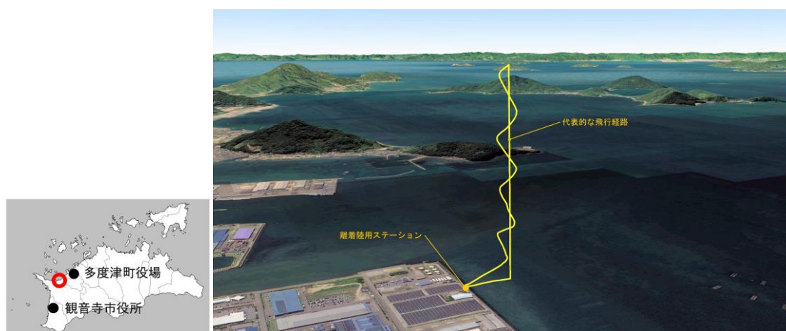
図2.2 2020年10月に実施した海面上PM 2.5 等の鉛直濃度分布測定の実施場所（左地図中の赤丸地点）および代表的な飛行経路。離着陸用ステーションから海側が北（岡山県方面）に相当する。
