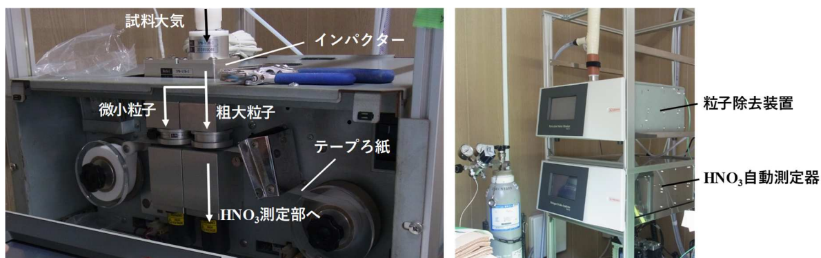
図5.2 粒子除去装置（左）および装置外観（右）
