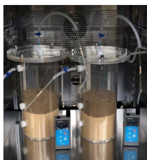
図(2)-4 土壌カラム試験のセットアップ (a) と被覆前 (b) 及び被覆後 (c) の様子
