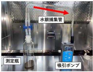
図(2)-2 バイアル瓶を用いた揮発量ポテンシャルの測定手順(a)及び測定の様子(b)
