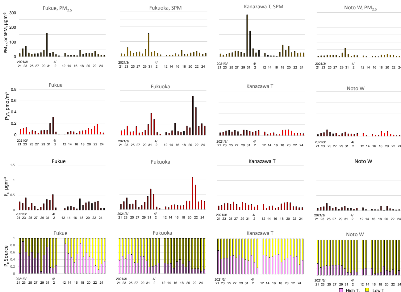
図3.7. 2021年黄砂飛来期の5地点の大気中PM 2.5 、SPM、P c 濃度及び発生源の推移
