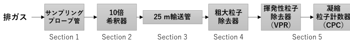
図-3.4. ICAO排出規制用の航空機排ガス粒子計測設備の概念図。
