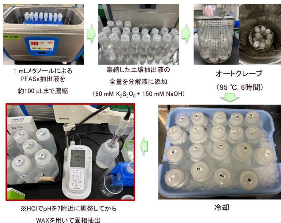
図4-3 土壌試料に適用可能なTop Assay法の検討手順
