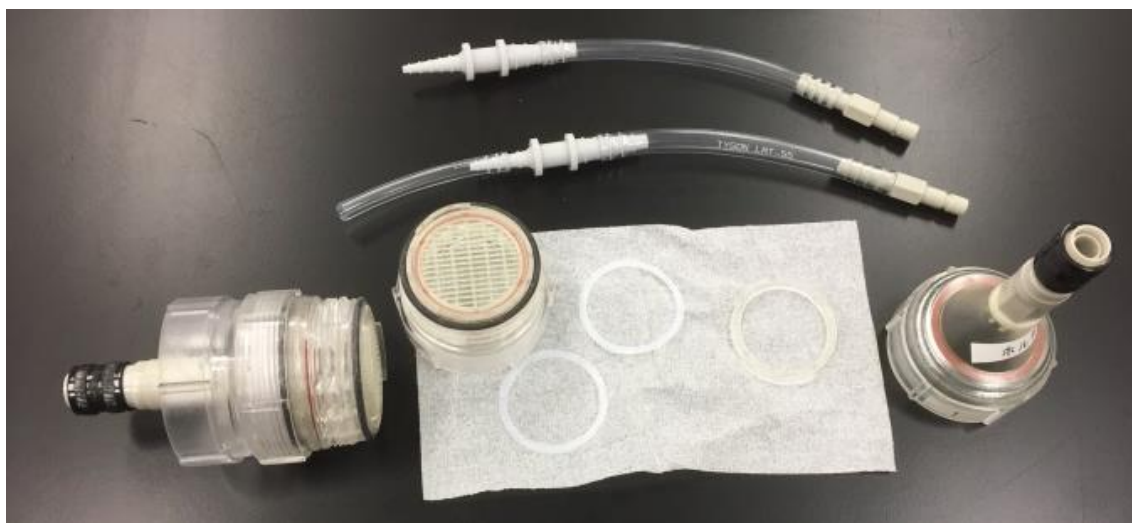
図10 本研究で使用したニールフィルターホルダーの分解写真
