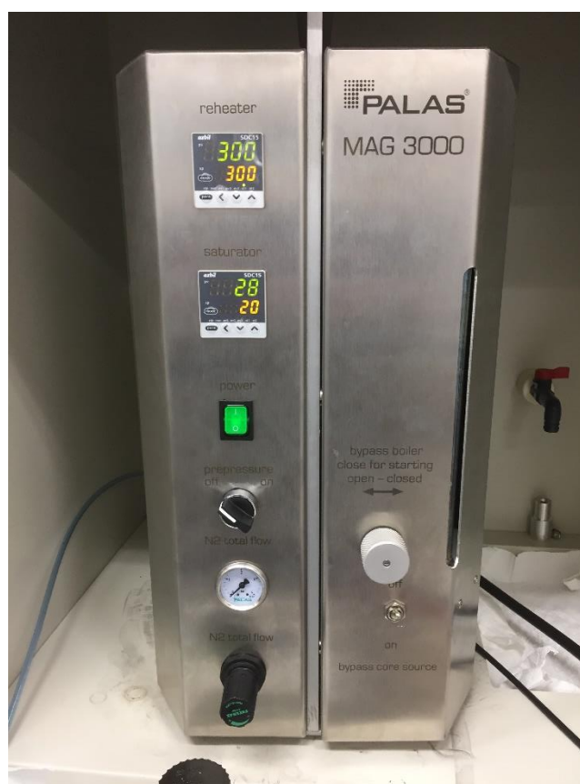
図14 凝縮型単分散粒子発生器（MAG 3000）
