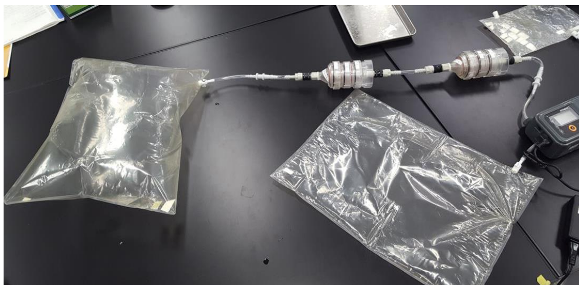
図11 ニールフィルターホルダーを使ってガスを捕集している様子
