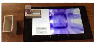
① 治具で試料セルをカメラ上に
