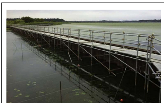
図4.1.6 柵の手前の有機汚泥を除去する印旛沼の復元実験 (Kadowaki et al. 2018)
