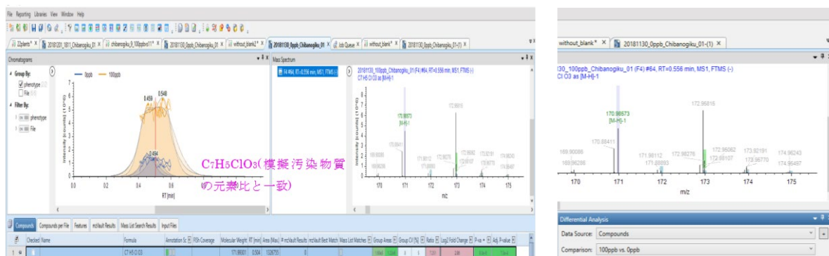
図1.2 模擬汚染物質の自動検知の様子 (左: 検出結果, 右: 標準物質のピーク強度比とp値) (成果の詳細より再掲)
