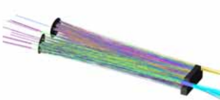
図-1.7 反射回数シミュレーション例
