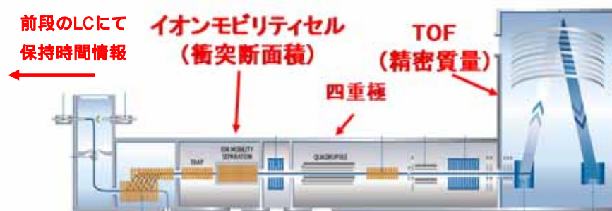
図-0.2 LC-QTOFMS (VION-IMS) の構造の模式図
