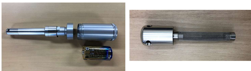
図2.1 セミアクティブ大気サンプラー（SAAS）の全体像（左）と内部に取り付けるステンレス製メッシュホルダー（右）
