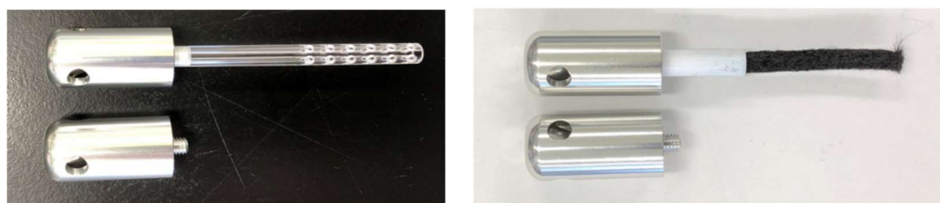
図2.2 PDMS石英捕集管（左）と吊り下げ型ACF捕集材（右）
