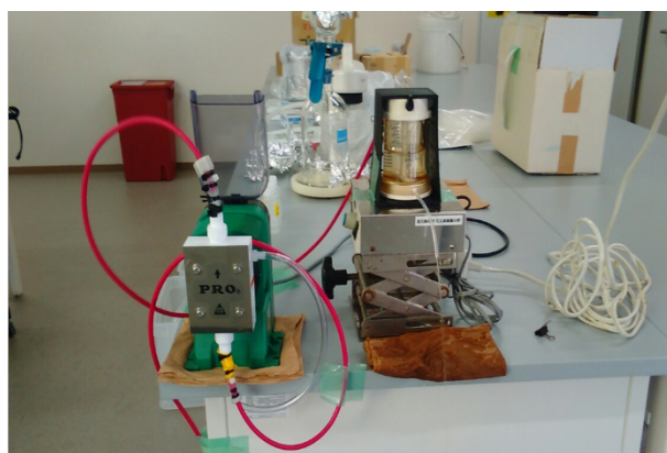
図4-3 海水中の微細粒子を抽出・濃縮するための限外濾過法を応用したシステム。右が攪拌式限外濾過セル、左が定流量ポンプ。
