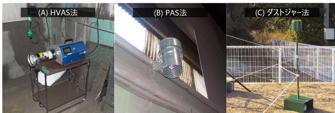
図1. 1. HVAS法、PAS法、およびダストジャー法によるサンプリング風景
