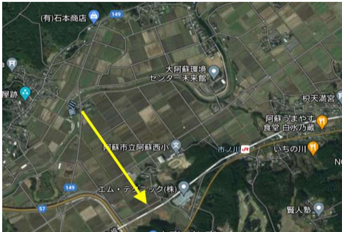
図 3.3 阿蘇市 17 工区付近の衛星画像 黒川から、黄色い線のように地下水道が埋設され、用水路に水を押し上げている。 熊本地震ではこうした地下の配管が大きく損壊した。
