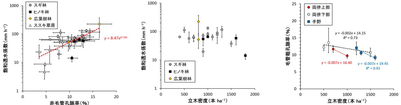
図3.15 (左) 透水性と大型孔隙の関係。(中央) 透水性と立木密度の関係。(右) 保水性と立木密度の関係
