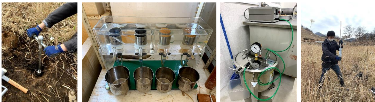
図3.1 (左から) 現場での土壌採取、定水位法による透水試験、加圧板法による保水性試験、簡易貫入試験器を用いた土壌深調査の様子
