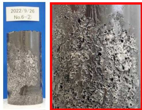
写真-1.4 埋立実験後のエポキシ樹脂固化体 (No. 6)
