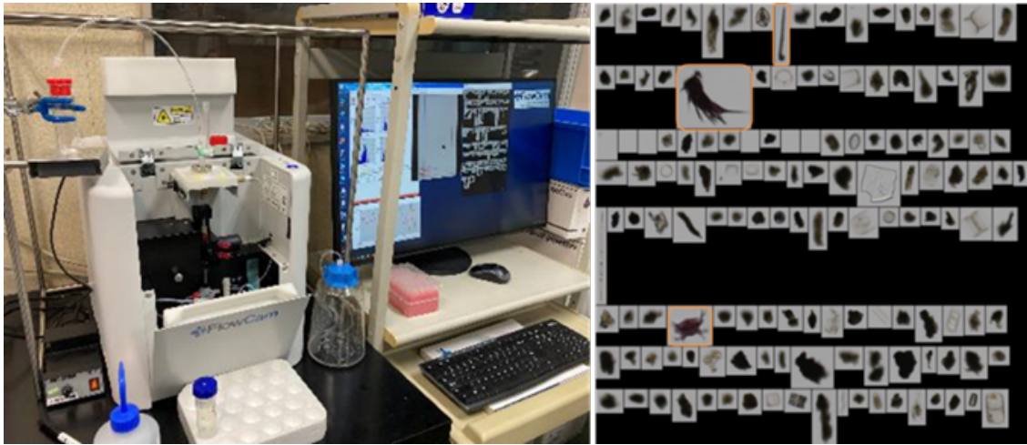
図24. FlowCAM8400の外観 (左) とFlowCAMによる画像取得中の生画像 (右)、大多数はメイオベントス以外の粒子であることが分かる
