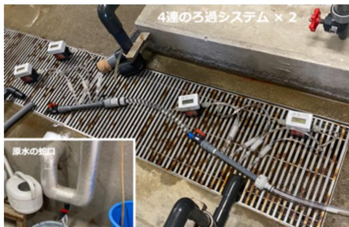
図II-2. 深層水原水の取水口(原水蛇口)に自作のろ過装置を接続し、汲み上げ水圧によるろ過を行っているところ。フィルターの出水孔に流量計を取り付けることでろ過水量をモニターした。4連のろ過装置を縦列することにより同時に8本のフィルターによる並列ろ過が可能となる。
