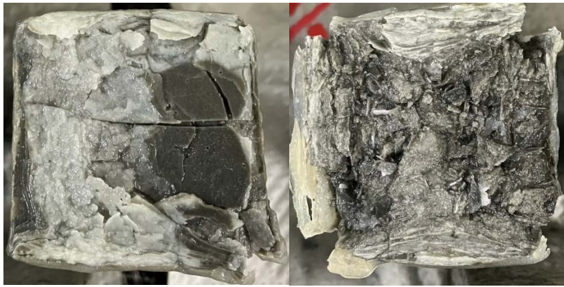
写真1.1 CsCl+CaCl 2 30%の浸漬溶液に7カ月浸漬した時点のOPCの浸透面の劣化
