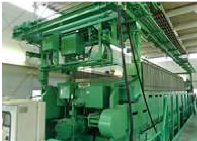
フィルタープレスは多数の平板カラムが並んだ構造
