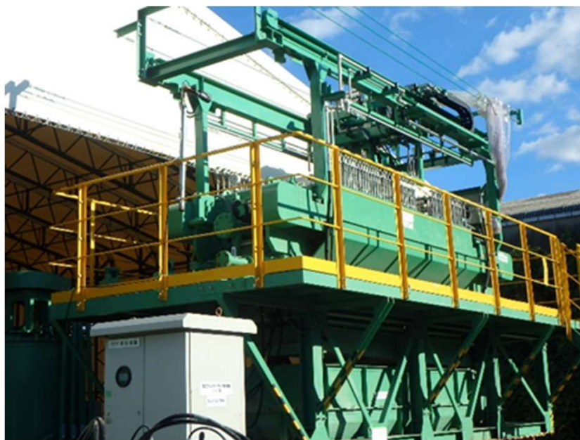
ろ室合計容量1m 3 の試験機 (りんかい日産建設)
