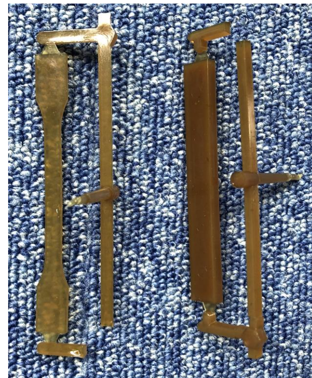
射出成型により得た試験片 (成形温度 190^{\circ}\text{C} ( T_m 176^{\circ}\text{C} , T_g 45^{\circ}\text{C} ))
