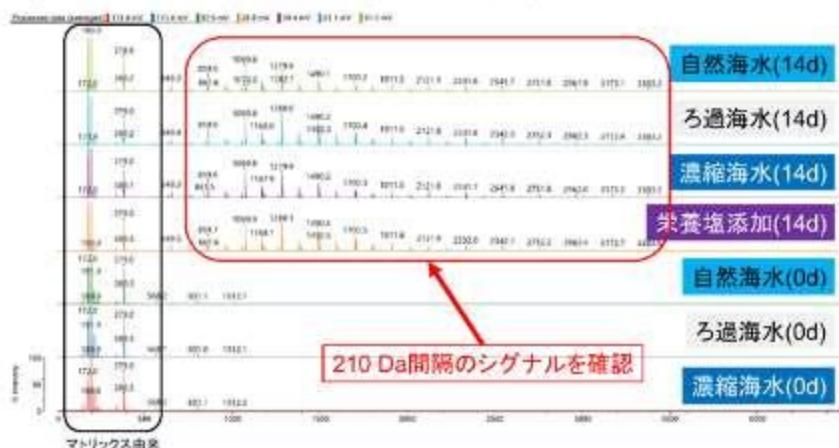
実環境を想定しつつ、試験液およびバイオナイロンを回収・分析するための自然光暴露実験を立ち上げ、Nylon 6iが水溶化する様子を捉えた。加えて、**溶解したバイオナイロンオリゴマーの分子状態を質量分析により特定した。(計画以上の成果)**
