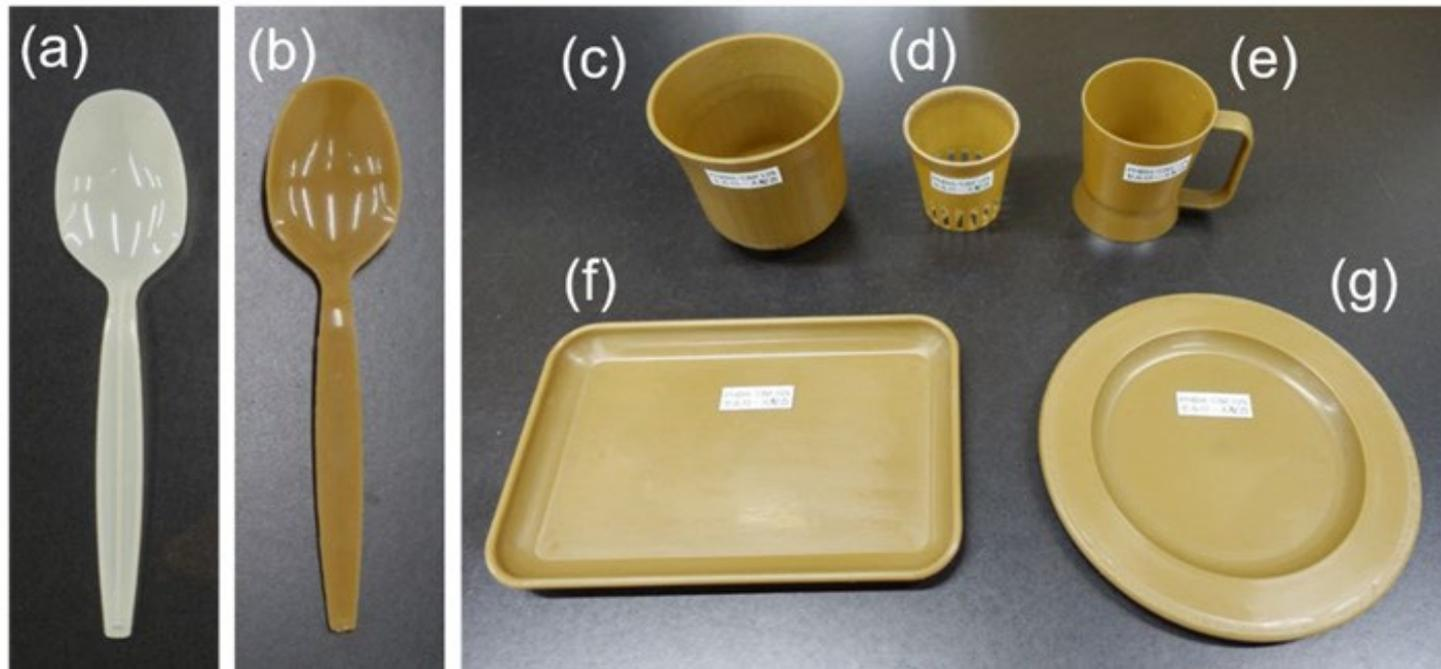
図0-13 ニートPHBH (a) および10wt%CNF複合PHBH (b-g) 成形品
