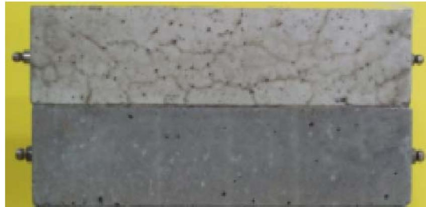
アルカリ骨材反応試験後の供試体の状況
