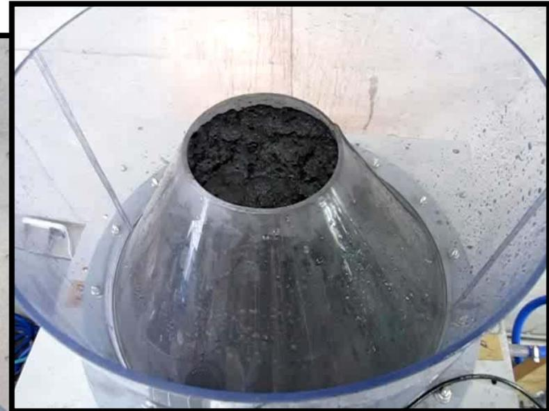
※本デバイスは未燃分離器の回路に取り付ける循環ポンプのみを動力源としており、省エネ型でコンパクトな低価格プラントである。
