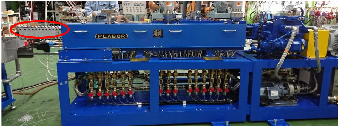
福岡大学が導入した樹脂溜まりを持つラボ押出機（赤丸内が樹脂溜まり）
