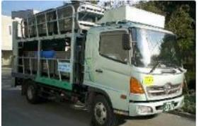
統一コンテナ (1m3/0.5m3) 統一コンテナ車両 (12m3)
