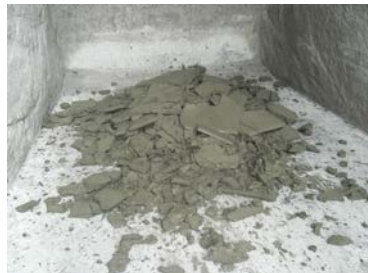
6 脱水後のスラッジケーキ
