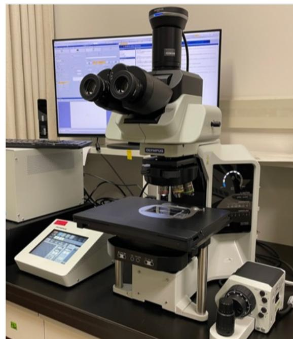
電動ステージを利用した、映像結合技術による高精細画像作成
