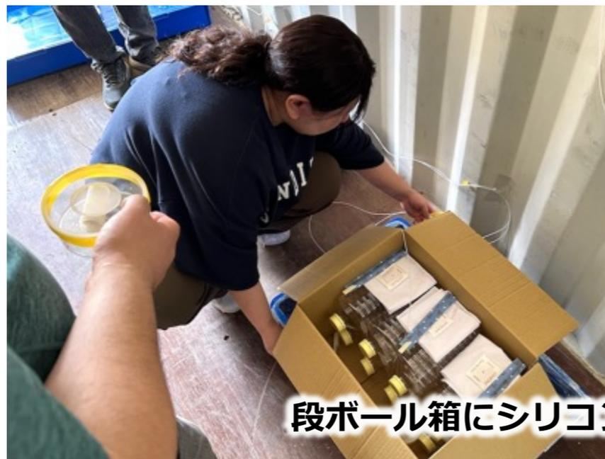
段ボール箱にシリコン細管を設置
