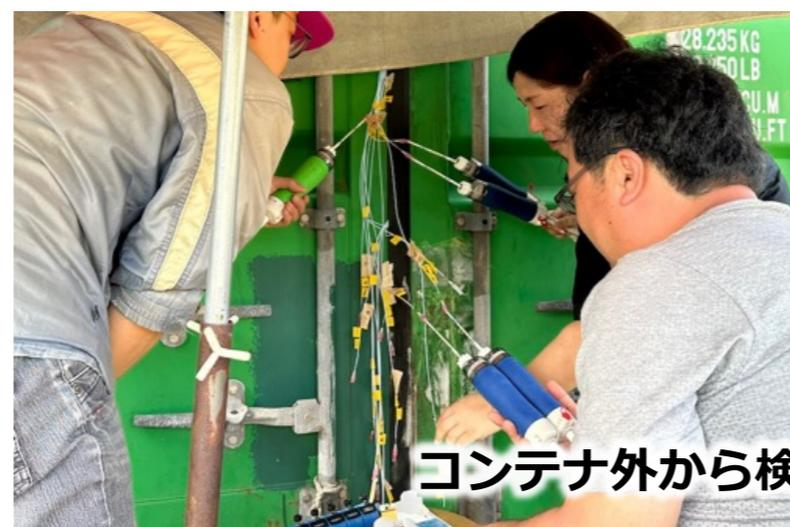
コンテナ外から検知管を用いて内部ガス量を測定
