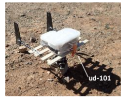
観測プロット・測器配置図(左)および飛砂計(右)
