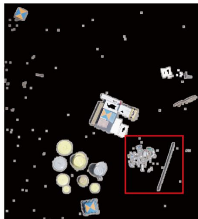
図4 海岸のオルソ画像の一部(左)と、それに深層学習による画像解析を適用し、疑似プラごみを検出した結果(右)。疑似プラごみ以外を黒で塗り潰している。
