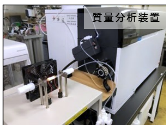
加熱脱着炉付 ICP-QQQ (自作 + Agilent8900)
