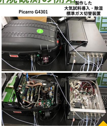
簡易設置型高精度大気中GHG観測システムを開発。安定した分析に成功。バッテリー駆動のため、観測場所の制限が非常に小さい。
