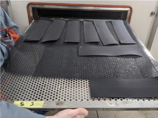
恒温器で乾燥させると、このように成形品は乾燥ムラにより反ってくる
