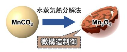
・Mn<sub>3</sub>O<sub>4</sub>多孔質球の粒子径制御
