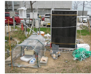
太陽光蓄熱乾燥装置 濃縮水の乾燥 (フロスの乾燥)
