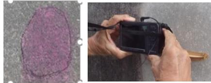
現場で染色後の顕微カメラを用いた撮影
