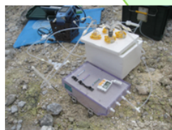
チャンバー法による土壌水銀揮発フラックスの現場観測
