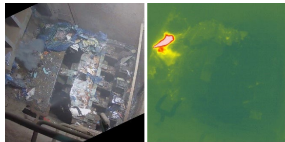
図 坂戸市の処理施設におけるLIB起因の発煙時のカメラ画像（左）と熱画像（右） Terazono A. et al. (2024) Resources, Conservation, & Recycling, 202, 107398
