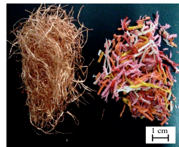
図 1 剥離試験後の銅線 および塩ビ被覆材の写真
