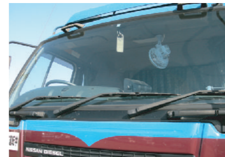
車内に小型扇風機を設置
