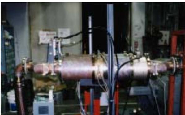
図2-3-2 エンジンベンチにおける触媒選定実験の概要
