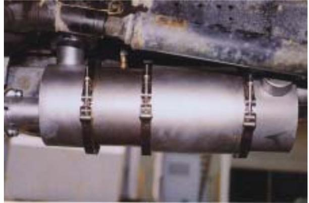
図2-2-1 DPF単体の外観(供試車両床下への装着状態)
