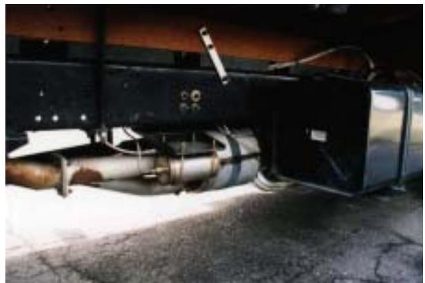
図3-1-1 自動車メーカー製DPFシステムの搭載状態
