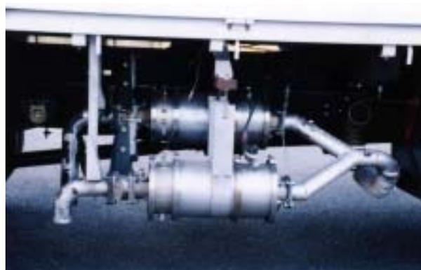
図2-3-1 DPFシステムの搭載状態(第2次汎用性向上型)
