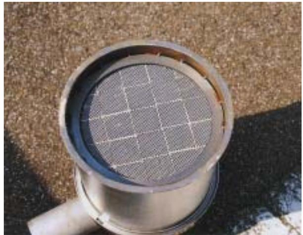
図2-2-3 炭化珪素(SiC)製フィルタ表面
