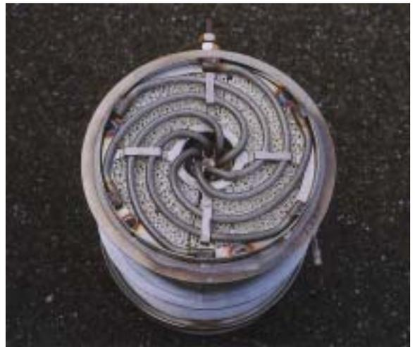
再生用電気ヒータ(渦巻き状ヒータ)
