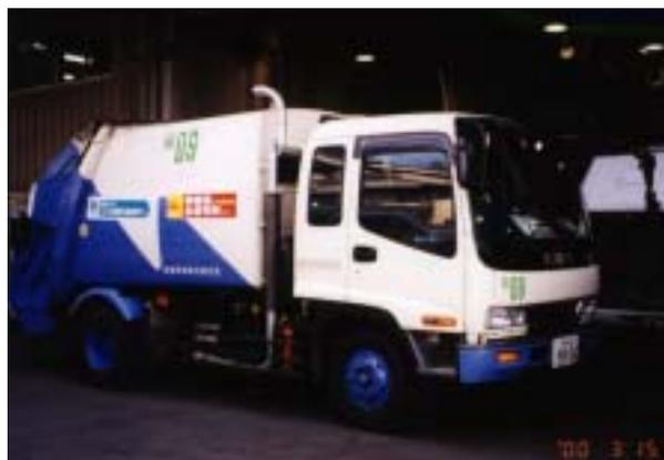
図3 - 2 - 4 自治体D塵芥車（3.35トン積み）
