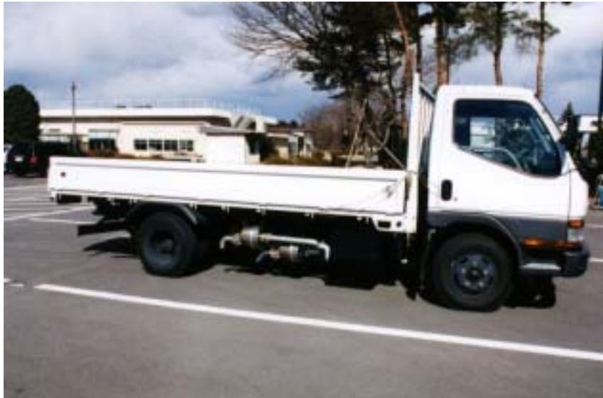
図2 - 4 - 3 第3次汎用性向上型DPFシステム装着車両
