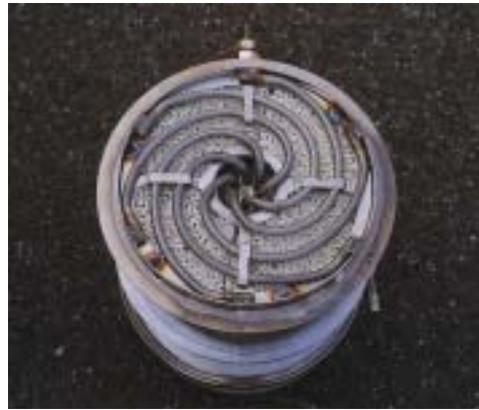
図2-2-2 再生用電気ヒータ(渦巻き状ヒータ)
