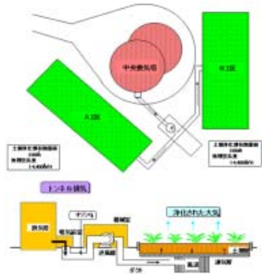
図 2 - 3 (1) トンネル型システムの概略図
