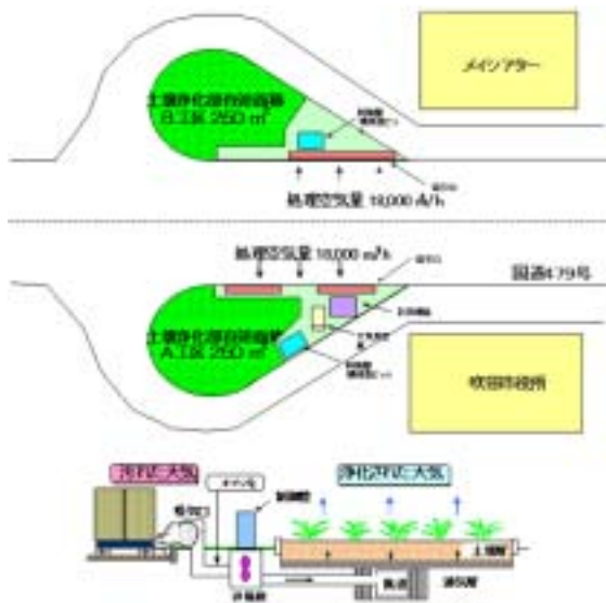
図 2 - 2 (1) 沿道型システムの概略図
