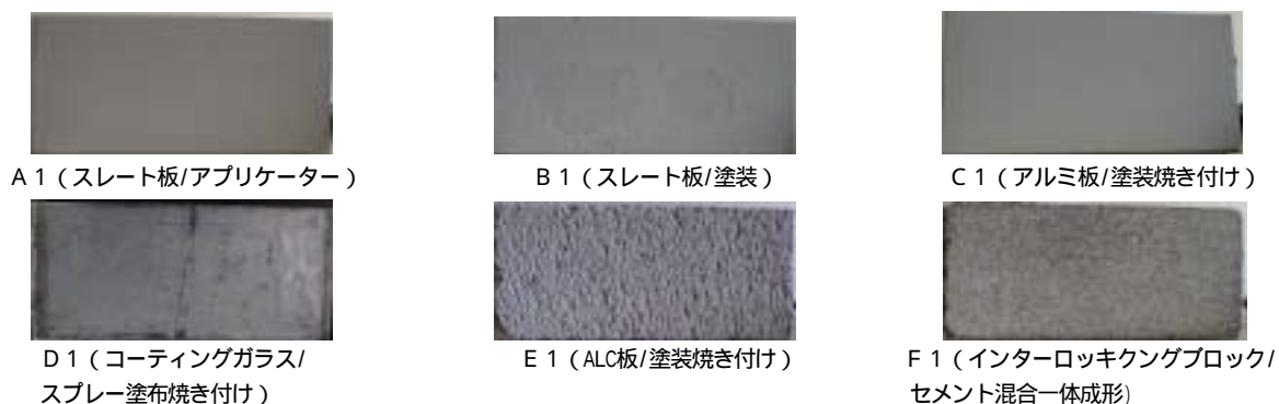
図 5 - 2 ( 1 ) 改良建材のテストピース
