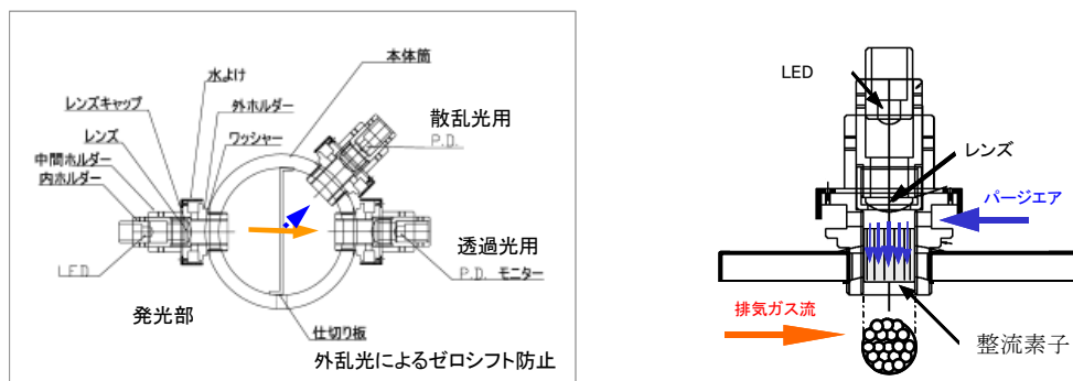
図 3-1 PM 光学系構成図
