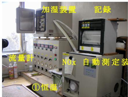
図 10 固定床流通反応装
