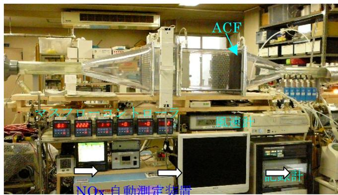
写真 3 小型風洞による薄型緻密ユニットの通風試験
