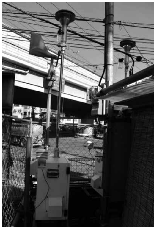
写真3 川崎臨港警察署前交差点の観測小屋における粒子捕集 左：FRM サンプラー 右：NanoMoudi II
