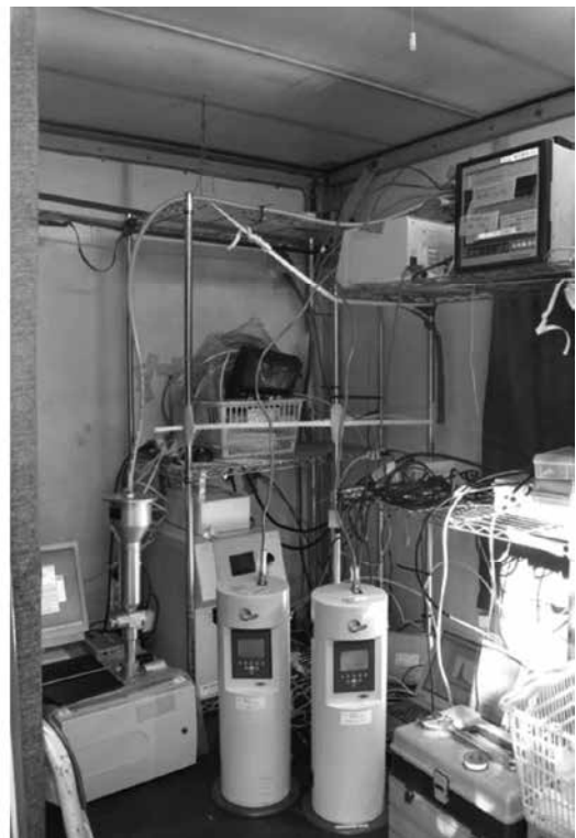
写真3 川崎臨港警察署前交差点の観測小屋における粒子捕集 左：FRM サンプラー 右：NanoMoudi II
