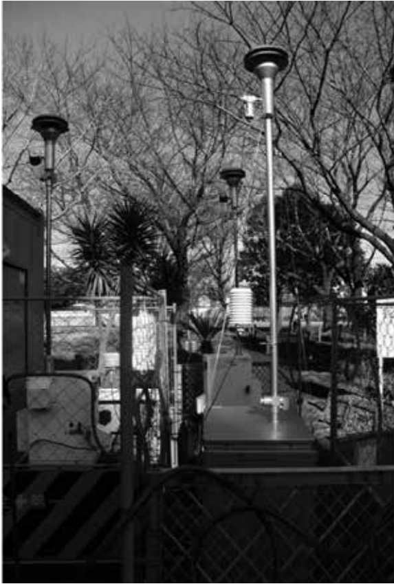
写真4 中留公園の観測小屋における粒子捕集 左：FRM サンプラー 右：NanoMoudi II
